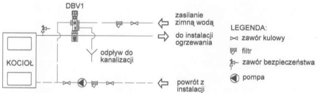
Рис.6 Схема інсталяції з двоканальним запобіжним клапаном DBV1.
